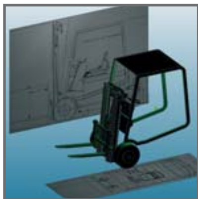
Abbildung 1 Fahrzeug mit Rasterimages zur Positionierung der Komponenten.
